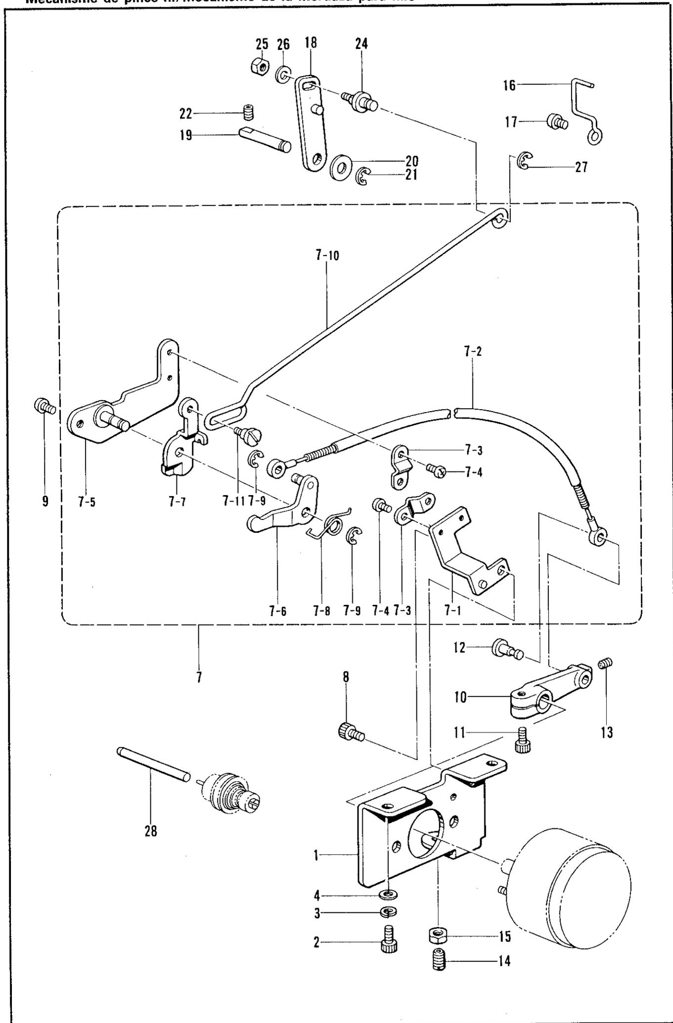
N. 糸締メ関係/Thread nipper mechanism/Fadenspannvorrichtung/
