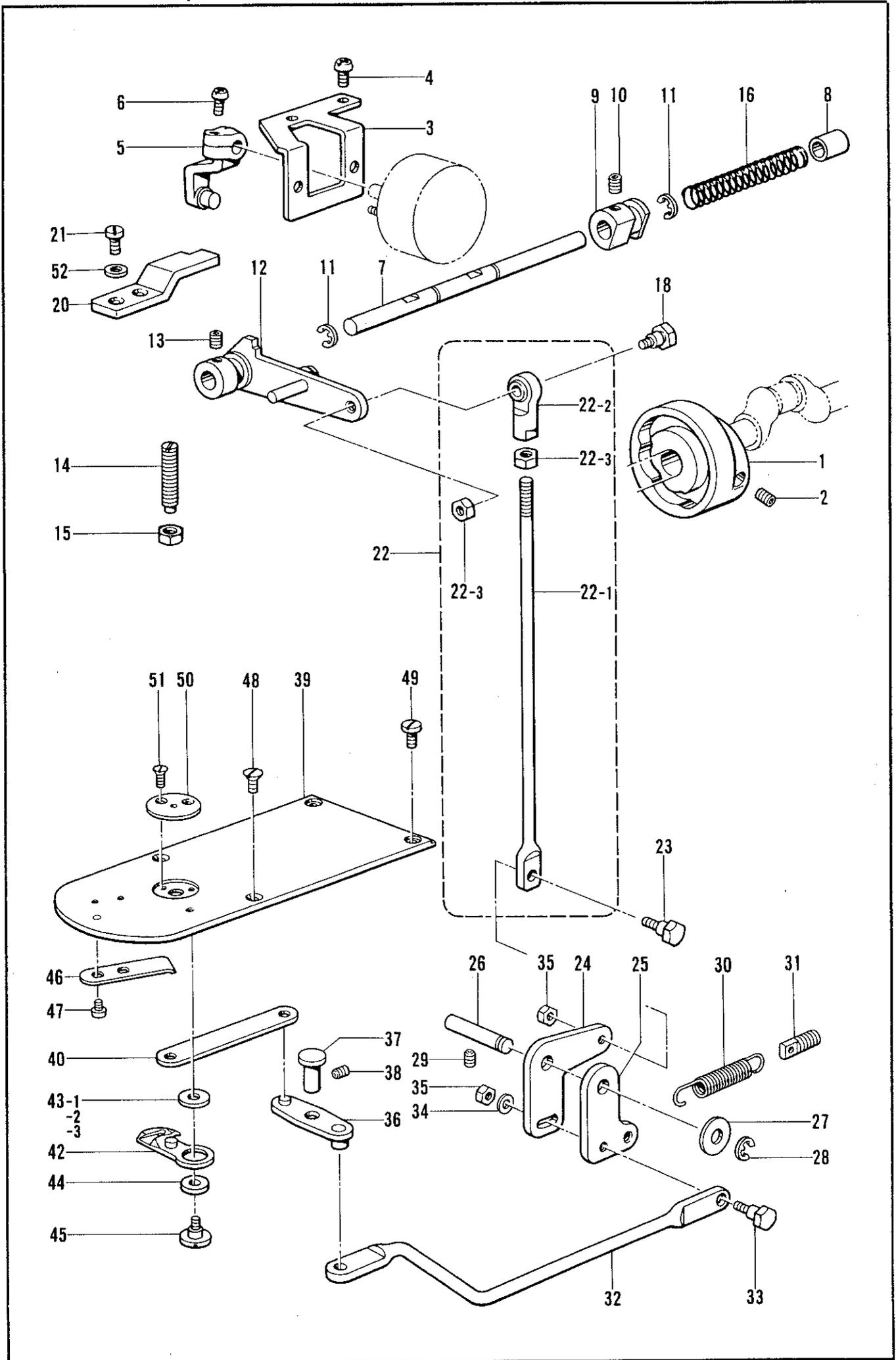
K. 糸切り関係/Thread trimmer mechanism/Fadenabschneidevorrichtung/
