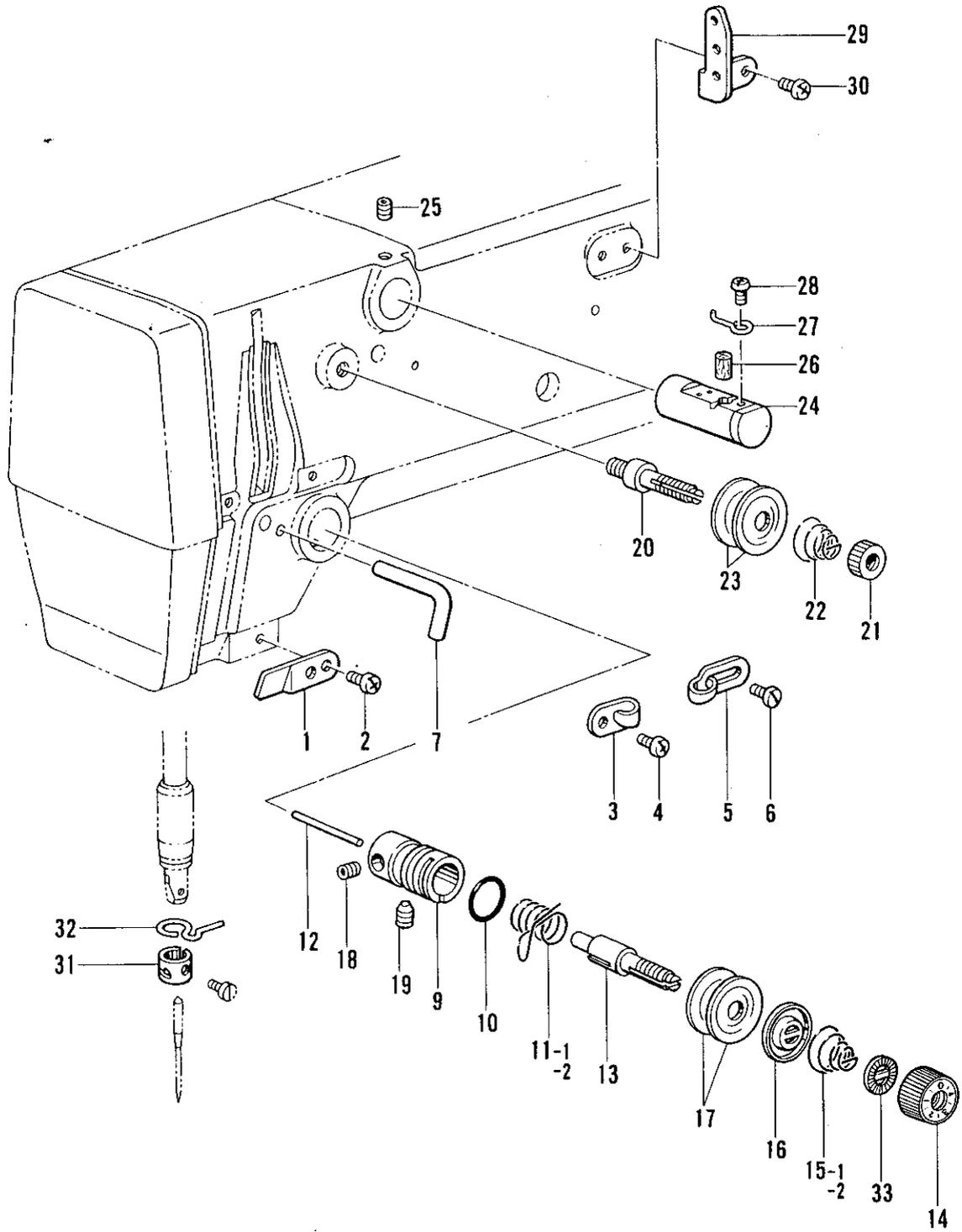
H. 糸通シ関係/Threading mechanism/FadenführungsVorrichtung/
