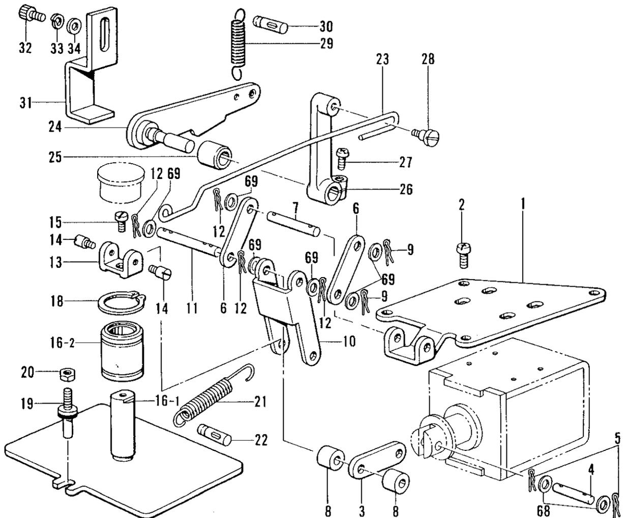
D. 押工上ゲ関係/Work clamp lifter mechanism/Stoffhalterhebevorrichtung/
