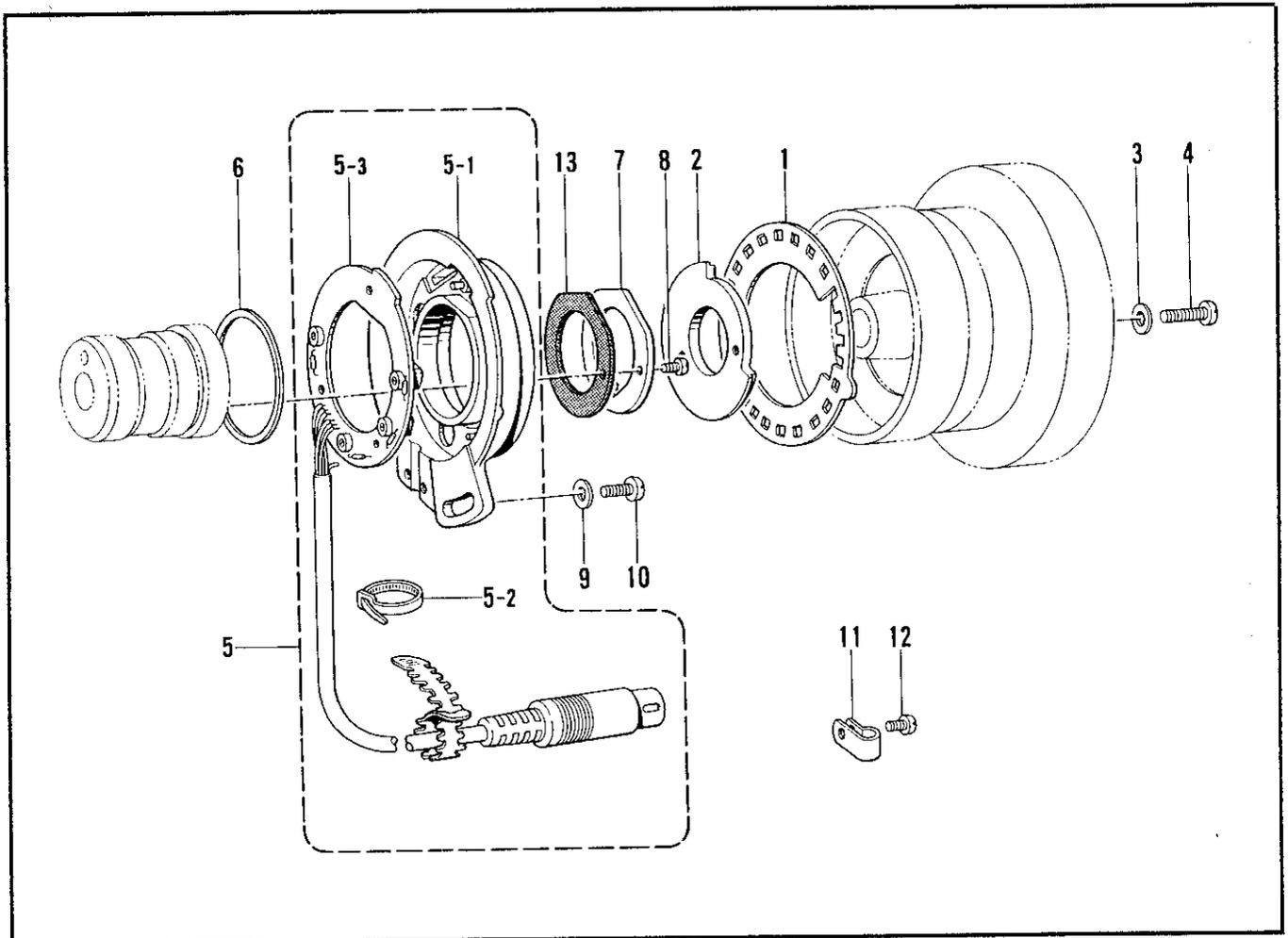
L. ワイパー関係/Thread wiper mechanism/Fadenwischvorrichtung/
