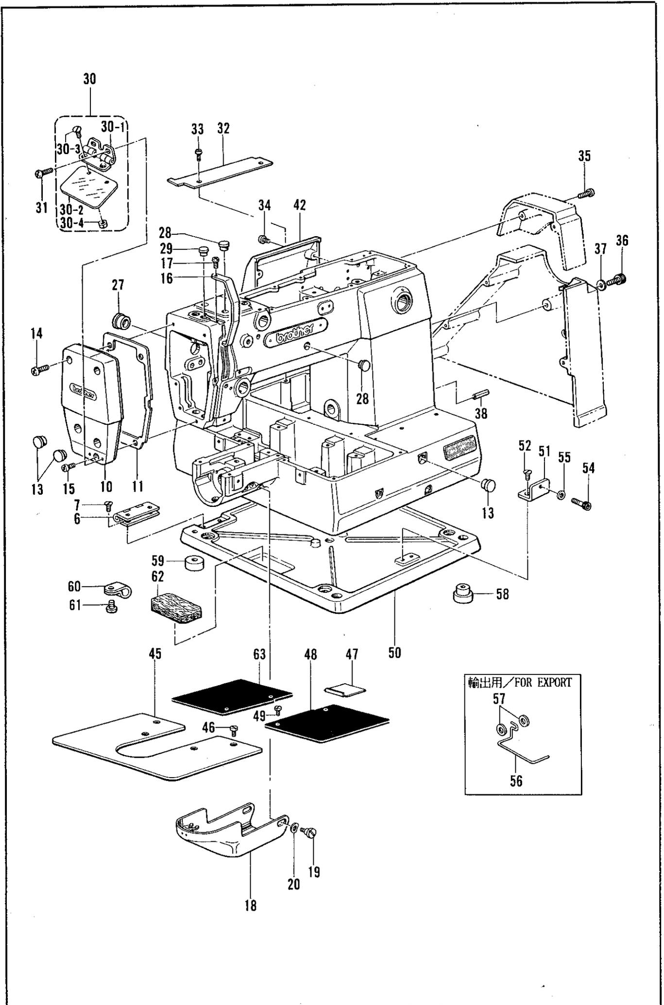
A1. 主体関係 / Machine body / Maschinengehäuse / Corps de la machine / Cuerpo de la máquina
