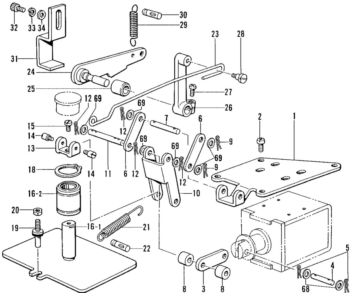
D. 押工上げ関係/Work clamp lifter mechanism/Stoffhalterhebevorrichtung/
